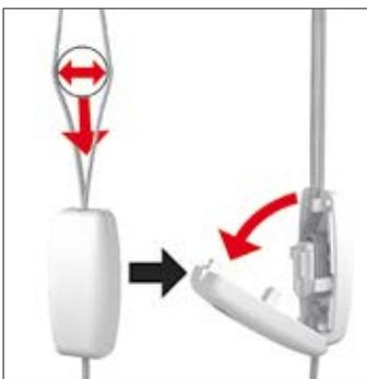
Alle schnurbedienten Anlagen werden mit einer Sicherheitsschnurquaste ausgeliefert. Diese öffnet sich, sobald die Schnüre 60 mm auseinandergezogen und gleichzeitig mit 6 kg belastet werden.
