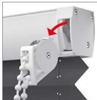
Kettenbediente Anlagen werden mit einem Sicherheitsgetriebe gefertigt. Dieses löst aus, sobald die Kette mit mehr als 6 kg belastet wird. Das Getriebe (Antriebsrad) kann anschließend selbstständig wieder montiert werden.
